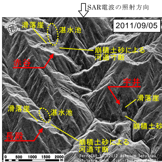
図-5 SAR画像による天然ダム発生状況
