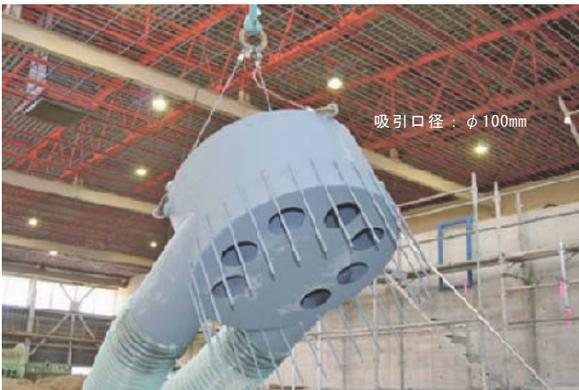
排砂管を吊り下げた底面部（7つの吸引口）の様子
