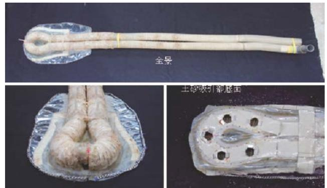
写真-1 φ100mm 潜行吸引式排砂管模型
