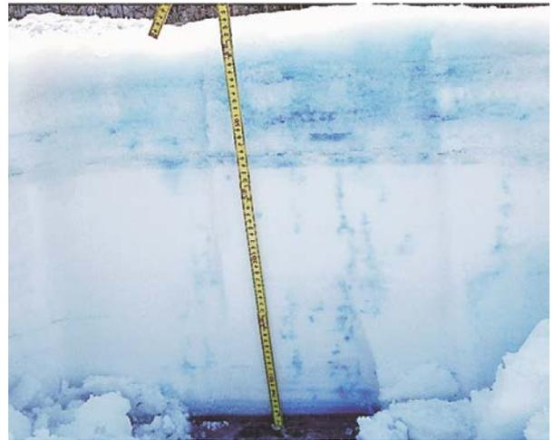
写真-1 積雪内の水みち形成の例
