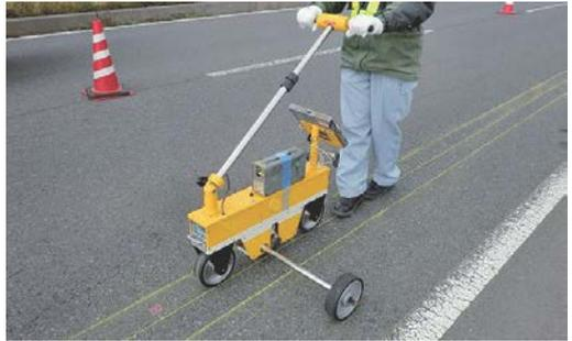
写真-2 小型プロファイルメータ（クラス2）
