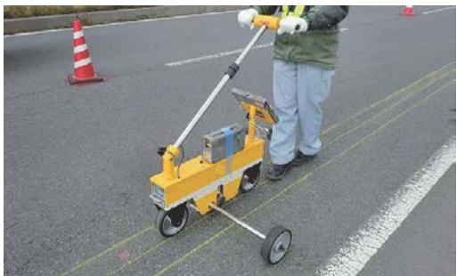
写真・2 小型プロフィルメータ（クラス2）
