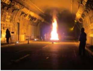
写真-2 火皿による模擬火災の状況
