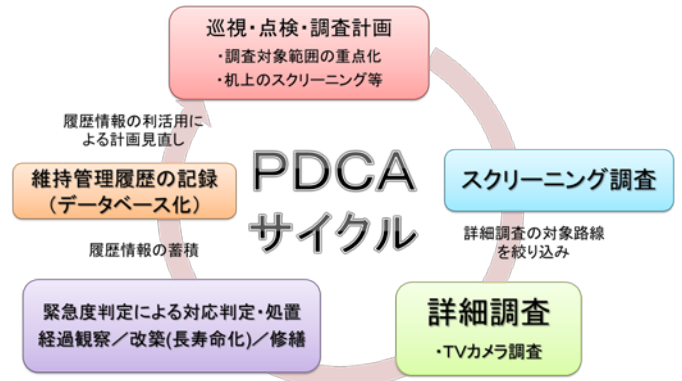
図-1 管渠マネジメントのPDCAサイクル 技術を導入する、新たな管渠マネジメントシステムを提案した。
