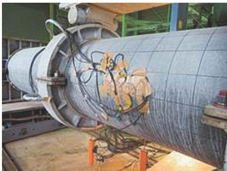
写真-2 3軸ゲージ取付け状況
