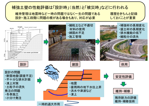
図-7 補強土壁の変状と対策 6)
