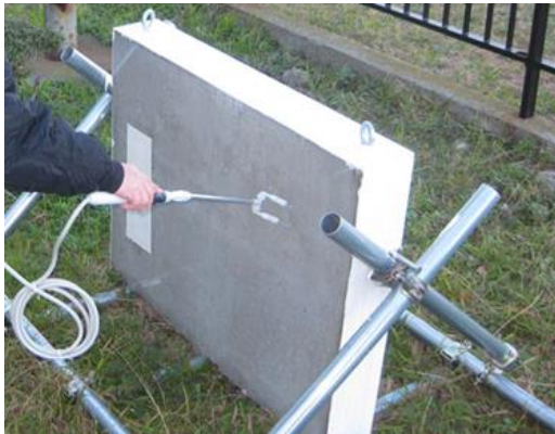
写真-2 塩水噴霧の状況
