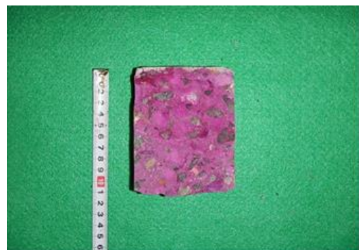
写真-3 暴露1年の中性化試験結果の例
