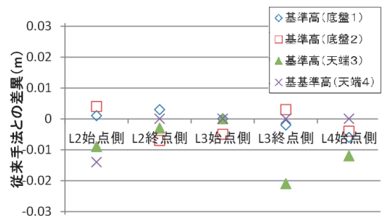
図-9 基準高の精度比較
