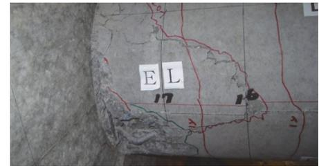
写真-3 E杭のひび割れ状況(+20 $\delta_y$ 時)
