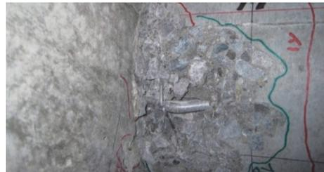
写真-2 E杭のスパイラル筋の破断状況(+9 $\delta_y$ 時)
