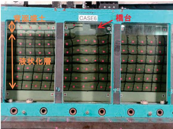
写真-3 加振後の状況 (現行基準の橋台の試験ケース)
