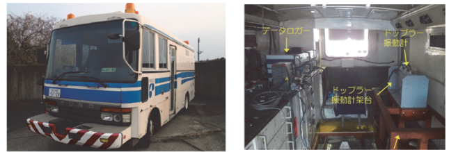
図-8 実道を走行可能な試作機 (左：車両外観，右：車両内部)
