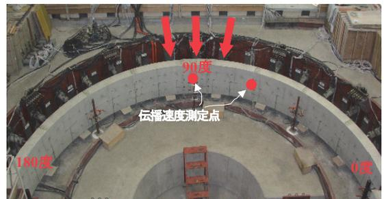
図-2 覆工載荷実験の状況
