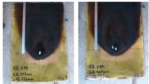
写真-7 NAV-G工法の延焼性試験後の状況 試験体消炎時間 左0秒 右0秒 基準30秒以内 上端延焼範囲 左426mm 右487mm 基準600mm以下
