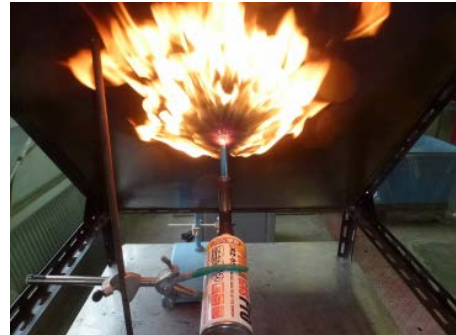
写真-6 延焼性試験状況
