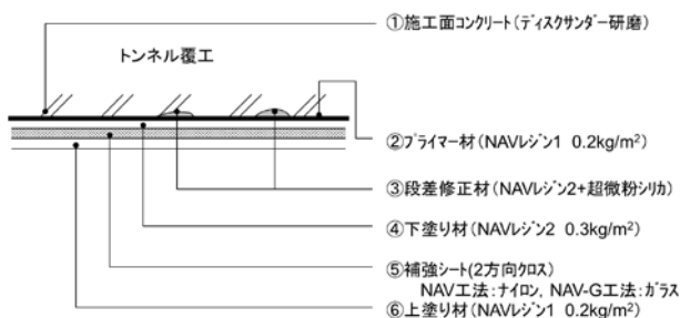
図-3 NAV工法・NAV-G工法の施工断面概念図
