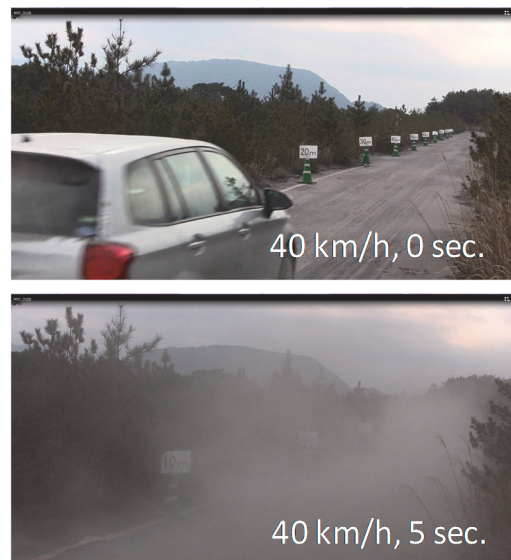
図-8 視認性試験における灰の巻き上げ (走行速度40km/hの例)
