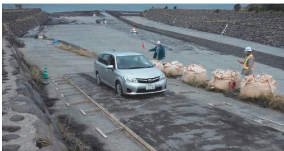
図-7 登坂能力試験の実施状況
