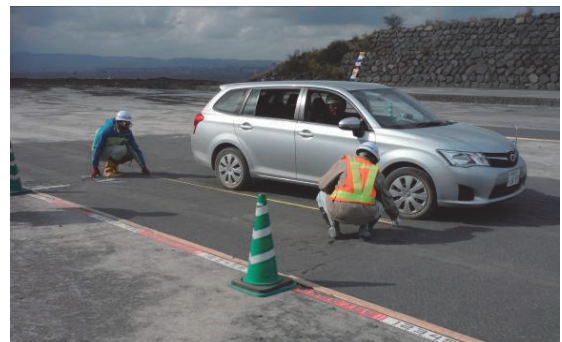
図-3 制動距離試験の実施状況
