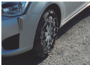
図-6 ゴム製タイヤチェーンの装着
