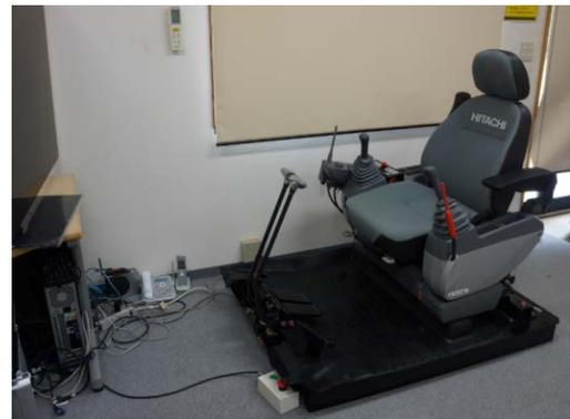
図-2 操縦席型操縦装置
