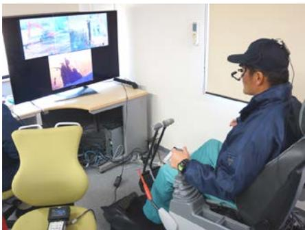
図-12 運転席型＋車載カメラ1台
