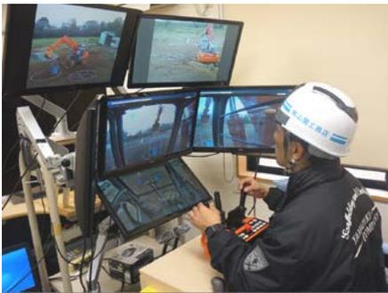
図-11 JS＋車載カメラ4台
