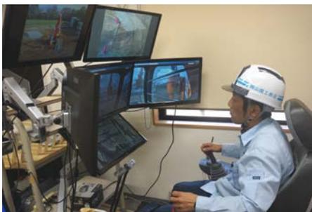
図-13 運転席型＋車載カメラ4台
