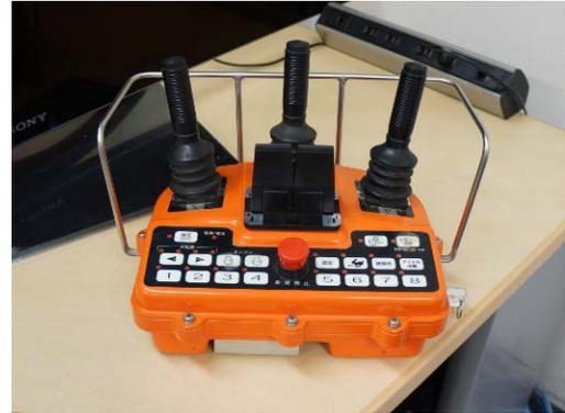
図-1 ジョイスティック型操縦装置
