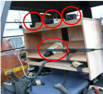
図-6 車載カメラ4台設置状況
