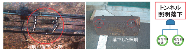
図-6 トンネル照明落下のフォールト・ツリー
