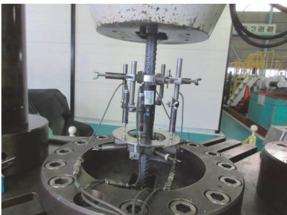
写真-3 一方向引張試験の荷重状況
