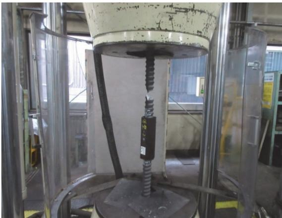
写真-4 塑性域正負繰返し試験後の破断状況
