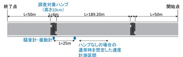
図-4 速度計測区間及び騒音計・振動計設置位置
