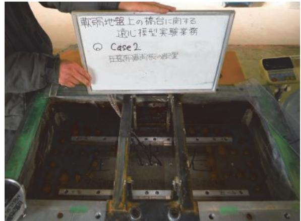
写真-2 予備圧密用載荷板の設置
