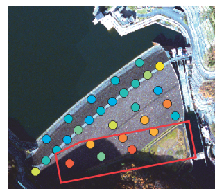
図-6 Hダムの衛星SAR強度画像(左上)、衛星SARによる外部変形量(右上、再掲)、RMSE(左下、再掲)洪水吐と導流壁(右下)
