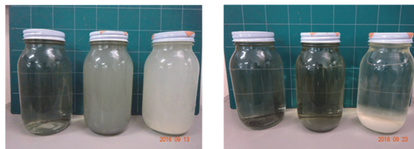
写真-3 固体硫黄の経時挙動 (左：実験開始時、右：静置10日後)
