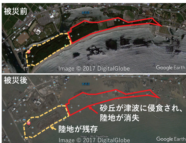
写真-1 砂丘が消失した事例（陸前高田市）
