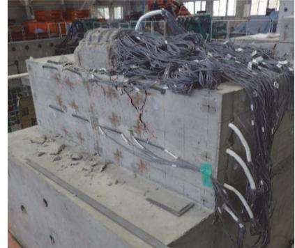
写真-4 橋座前面の破壊性状(ケース④)
