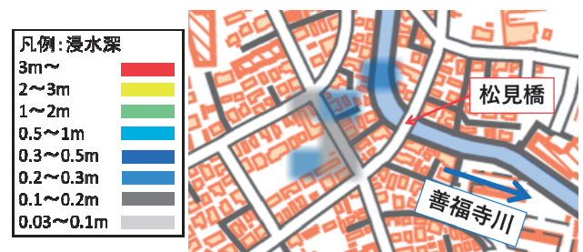
図-2 2019年10月12日の基準時刻14時10分における15時10分時点の浸水予測結果（善福寺川松見橋付近）
