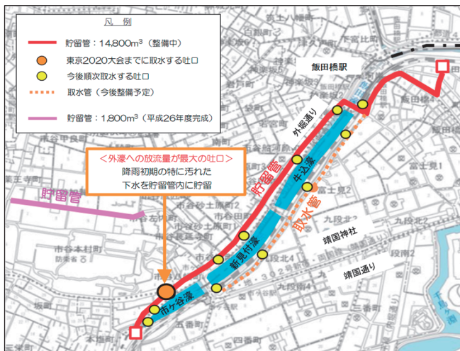
図-4 外濠の合流改善対策施設の整備
