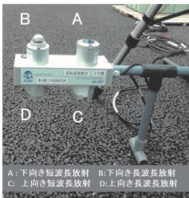
写真-4 長短波長放射計<sup>10)</sup>
