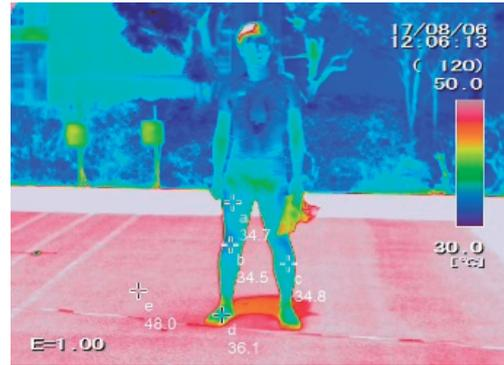
写真-3 赤外線カメラによる人体表面温度測定例<sup>6)</sup>
