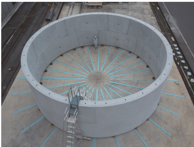
写真-1 RCセグメント工場仮組み状況
