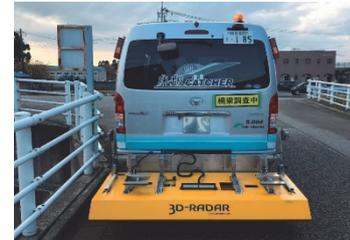
写真-7 車載式電磁波レーダ
