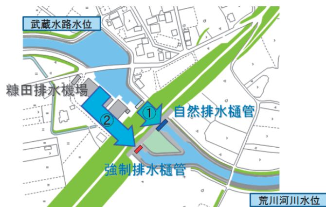
図-2 糠田排水機場の運転条件
