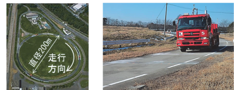
写真-1 舗装走行実験場（つくば市） （左：上空からの全景、右：荷重車）
