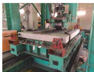
写真-5 走行疲労試験
