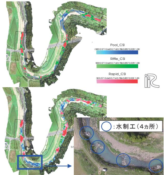
図-5 水制工なし(上図)とありの場合(下図)の出水後の流況に対する瀬淵の分布
