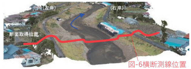
図-4 UAV写真測量により作成したC川の3次元点群モデル(一部区間)
