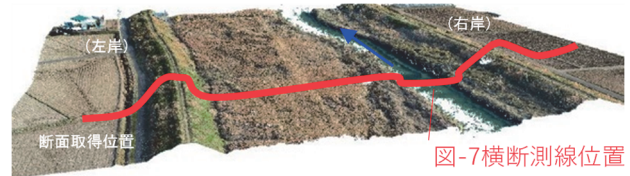
図-5 UAV写真測量により作成したE川の3次元点群モデル(一部区間)
