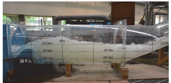
図-7 減勢池部の水理模型実験の様子
