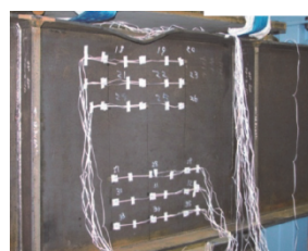
②上フランジの座屈 2) ③ウェブのせん断座屈
