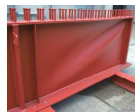
②上フランジの座屈 2) ③ウェブのせん断座屈
