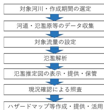
図-8 小規模河川の氾濫推定図作成・活用手順<sup>2)</sup>を一部修正
