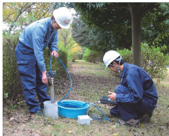
図-1 孔内傾斜計観測の概要
