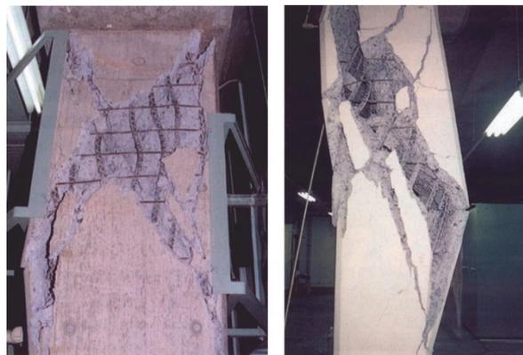
写真-1 せん断破壊の事例
