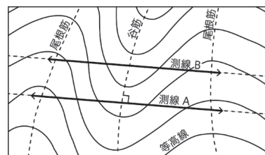
図-4 集水地形を捉える測線配置
