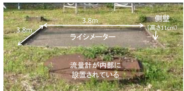
図-2 積雪ライシメーターの設置例
